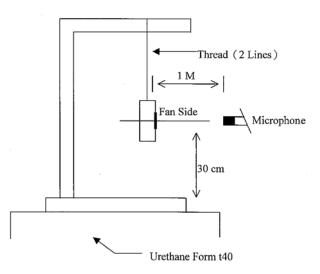
1 METER FROM MICROPHONE TO FAN INTAKE
