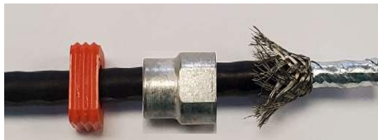
Figure / Abbildung 3.1.3.1: Preparation of the braid / Vorbereitung Schirmgeflecht
