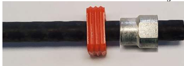
Figure / Abbildung 3.1.1.1: Slipping over Ferrule and Single wire Seal / Überstreifen von Fixierelement und Dichtung
