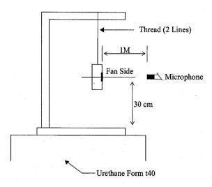
1 METER FROM MICROPHONE TO FAN INTAKE
