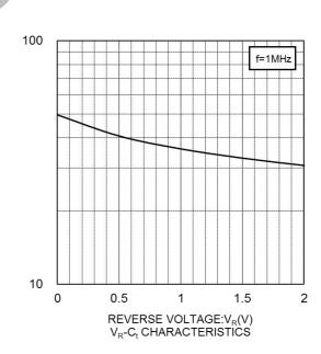
CAPACITANCE BETWEEN TERMINALS:C<sub>i</sub>(pF)
