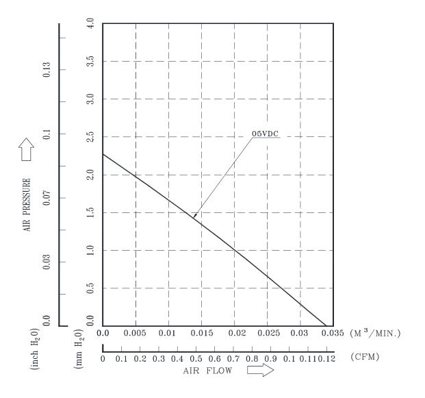
\*TEST CONDITION: INPUT VOLTAGE-----OPERATION VOLTAGE TEMPERATURE-----ROOM TEMPERATURE HUMIDITY-----65%RH
