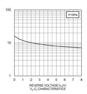
CAPACITANCE BETWEEN TERMINALS:C<sub>t</sub>(pF)
