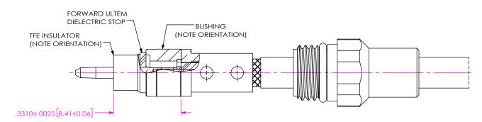
4. SLIDE BUSHING, FORWARD ULTEM STOP & FORWARD TEFLON INSULATOR OVER CONTACT AS SHOWN.
