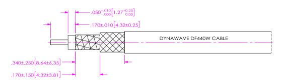
1. TRIM CABLE TO EXPOSE CENTER CONDUCTOR, DIELECTRIC AND BRAIDS AS SHOWN.
