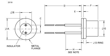
Ref Millimetres А 11.05 ± 0.25 В  $6.10 \pm 0.25$ С 3.56 ± 0.13 D 63.5 min Е 1.0 F G 8.2 max Н 9.53 1.5 J \* sensing element  $6.25 \pm 0.50$
