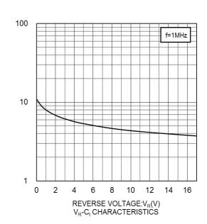
CAPACITANCE BETWEEN TERMINALS:C<sub>t</sub>(pF)
