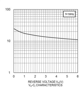
CAPACITANCE BETWEEN TERMINALS:C<sub>t</sub>(pF)
