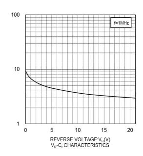
CAPACITANCE BETWEEN TERMINALS:C<sub>t</sub>(pF)
