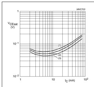
Transistor TR2;  $I_C/I_B = 20$ .
