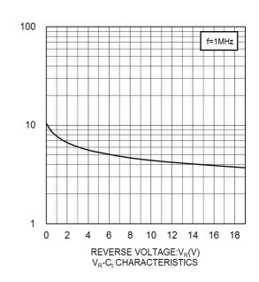
CAPACITANCE BETWEEN TERMINALS:C<sub>t</sub>(pF)
