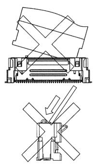
解除レバーを押さずに FFC/FPC を引き抜きますと、コネクタもしくは FFC/FPC が破損する可能性がございます。
