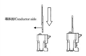
②FPC/FFC はコジらず、真直ぐ挿入してください。 Please insert FPC/FFC straight.
