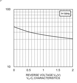
CAPACITANCE BETWEEN TERMINALS:C<sub>i</sub>(pF)
