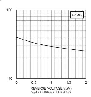
CAPACITANCE BETWEEN TERMINALS:C<sub>f</sub>(pF)
