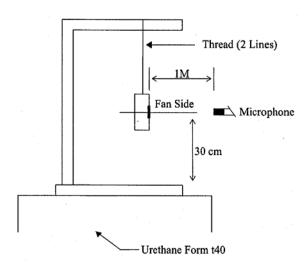
1 METER FROM MICROPHONE TO FAN INTAKE
