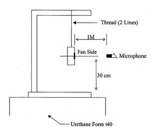
1 METER FROM MICROPHONE TO FAN INTAKE
