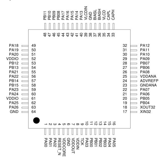
Figure 3-4. ATSAM4LC TQFP64/QFN64 Pinout
