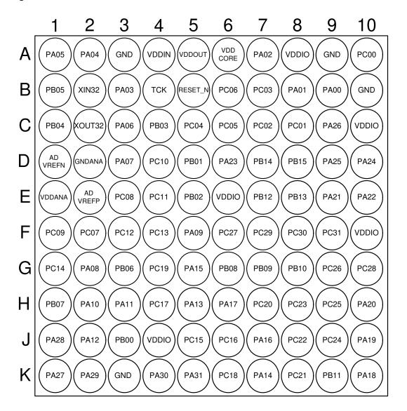
Figure 3-8. ATSAM4LS WLCSP64 Pinout
