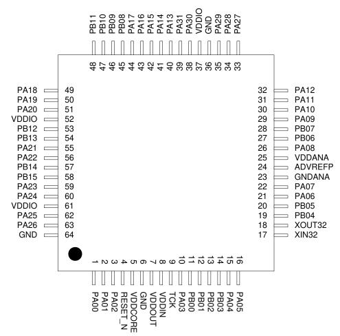
Figure 3-9. ATSAM4LS TQFP64/QFN64 Pinout
