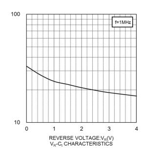
CAPACITANCE BETWEEN TERMINALS:C<sub>((PF)</sub>
