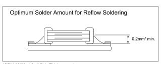
\*GRM 02/03: 1/3 of Chip Thickness min.
