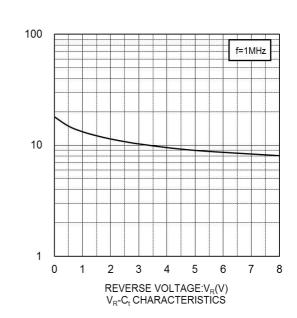
CAPACITANCE BETWEEN TERMINALS:C<sub>t</sub>(pF)
