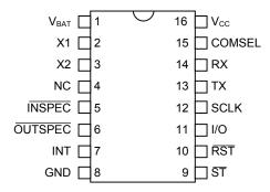
DS1615 16-Pin DIP (300 mil) DS1615S 16-Pin SOIC (300 mil) **Ton View**
