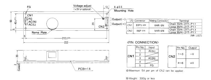
※ Dimensions in mm. ※ PCB Material: Glass composite (CEM 3)
