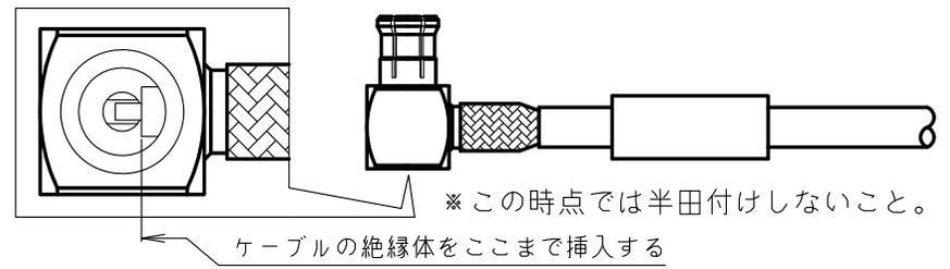
△2 本体を同軸ケーブルの絶縁体と外部導体の間に装着し、ケーブルの絶縁体部を図の位置まで挿入する。
