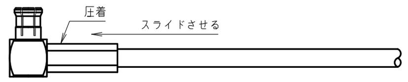
3 圧着スリーブを本体の根元までスライドさせ、圧着工具のA部で圧着を行なう。
