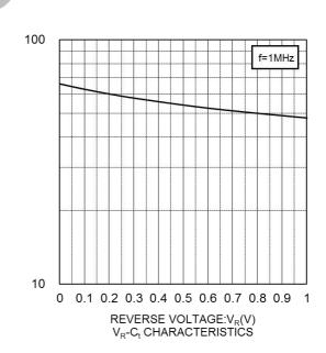
CAPACITANCE BETWEEN TERMINALS:C<sub>(</sub>(pF)
