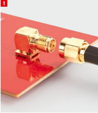
1 Prüfen Sie die Schnittstelle des Steckers vor dem Verschrauben visuell. Vermeiden Sie Schmutz oder einen falschen Mittelbolzen, um keine Schäden zu verursachen.
