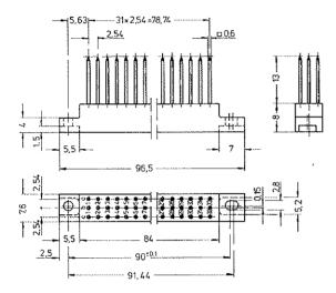
Wiring strips VE 64-ac-0,6 x 0,6 mm
