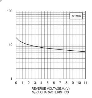
CAPACITANCE BETWEEN TERMINALS:C<sub>t</sub>(pF)
