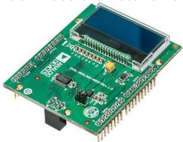
► CN0338 NDIR Gas Sensing shield
