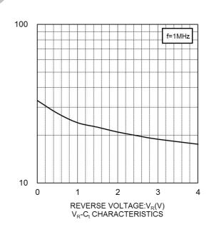
CAPACITANCE BETWEEN TERMINALS:C<sub>f</sub>(pF)
