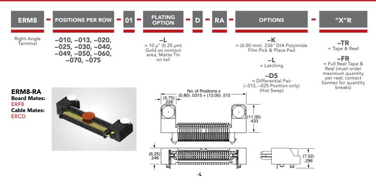
View complete specifications at: samtec.com?ERM8-RA
