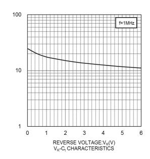
CAPACITANCE BETWEEN TERMINALS:C<sub>t</sub>(pF)
