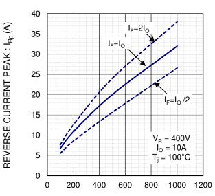
RATE OF CHANGE OF CURRENT :  $-di/dt(A/\mu s)$   $di/dt-I_{Ro}$  CHARACTERISTICS
