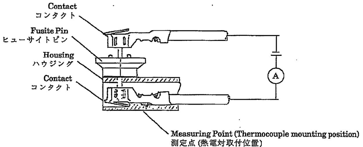
リード線の長さは熱の発散のため 150 mm とし試験電線は 0.75 mm<sup>2</sup> (AWG#18) とする。
