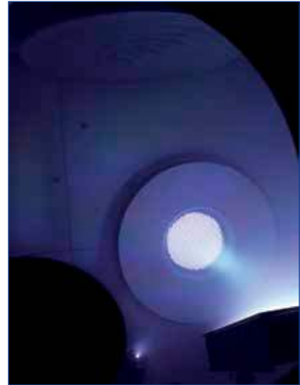
Ionenquelle eines Ionenstrahlverdampfers (Sputter)
