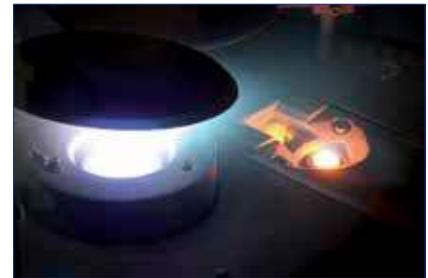
Beschichtungsanlage mit einem plasma-gestützten Elektronenstrahlverdampfer
