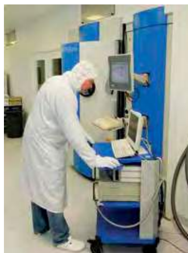
Einstellung der Parameter an einer unserer Coatinganlagen Setting of parameters at one of our coating units
