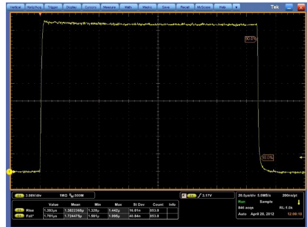
PCM-7510, 250 A, 150 \mu s pulsewidth
