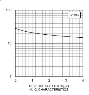
CAPACITANCE BETWEEN TERMINALS:C<sub>(</sub>(pF)
