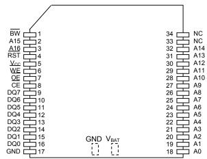
34-Pin PowerCap Module (PCM) (Uses DS9034PC PowerCap)
