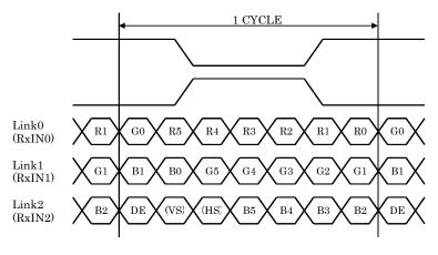
$\begin{array}{l} \textbf{DE} : \textbf{DATA ENABLE} \\ \textbf{HS} : \textbf{H}_{SYNC} \\ \textbf{VS} : \textbf{V}_{SYNC} \end{array}$
