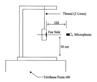
1 METER FROM MICROPHONE TO FAN INTAKE
