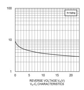
CAPACITANCE BETWEEN TERMINALS:C<sub>t</sub>(pF)
