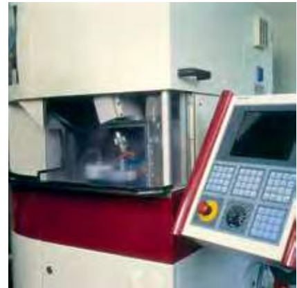
Optikfertigung mit CNC Poliermaschine Optics production with a CNC polishing unit
