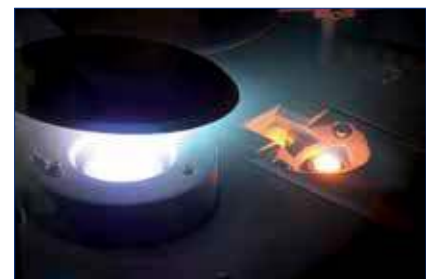
Beschichtungsanlage mit einem plasma-gestützten Elektronenstrahlverdampfer
