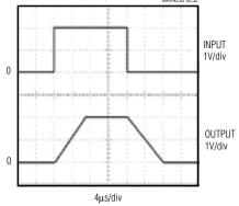
$$\begin{split} &V_{CC}=\pm 2.5V\\ &R_L=1k\Omega,\;C_L=15pF\\ &A_V=1V/V \end{split}$$
