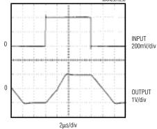
$$\begin{split} &V_{CC}=\pm 2.5V\\ &R_L=1k\Omega,\;C_L=15pF\\ &A_V=5V/V \end{split}$$
