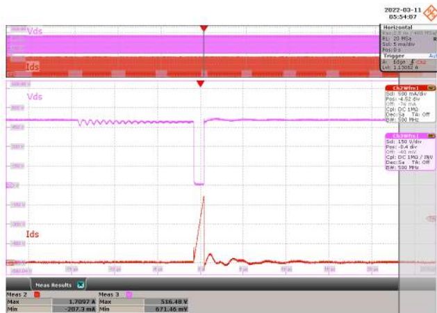
Figure 45 – 500 VDC Input. CH2: I_{DS} , 500 mA / div., 5 ms / div. CH3: V_{DS} , 150 V / div., 5 ms / div. Zoom: 5 \mu s / div. V_{DS(MAX)} = 516.48 V, I_{DS(MAX)} = 1.7097 A.
