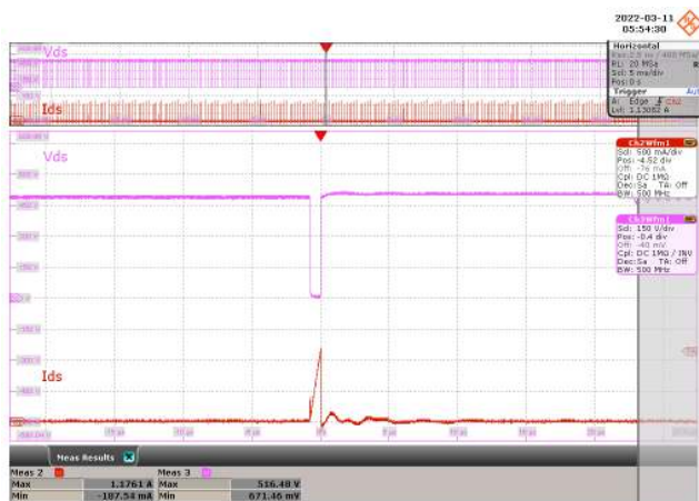
Figure 53 – 500 VDC Input. CH2: I_{DS} , 500 mA / div., 5 ms / div. CH3: V_{DS} , 150 V / div., 5 ms / div. Zoom: 5 \mu s / div. V_{DS(MAX)} = 516.48 V, I_{DS(MAX)} = 1.1761 A.
