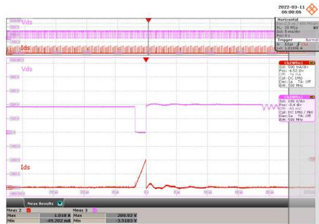
Figure 50 – 200 VDC Input. CH2: I_{DS} , 500 mA / div., 5 ms / div. CH3: V_{DS} , 100 V / div., 5 ms / div. Zoom: 5 \mu s / div. V_{DS(MAX)} = 209.92 V, I_{DS(MAX)} = 1.018 A.
