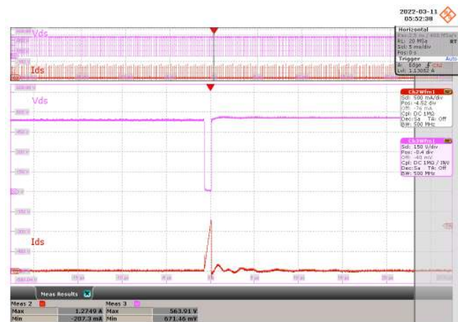
Figure 54 – 550 VDC Input. CH2: I_{DS} , 500 mA / div., 5 ms / div. CH3: V_{DS} , 150 V / div., 5 ms / div. Zoom: 5 \mu s / div. V_{DS(MAX)} = 563.91 V, I_{DS(MAX)} = 1.2749 A.
