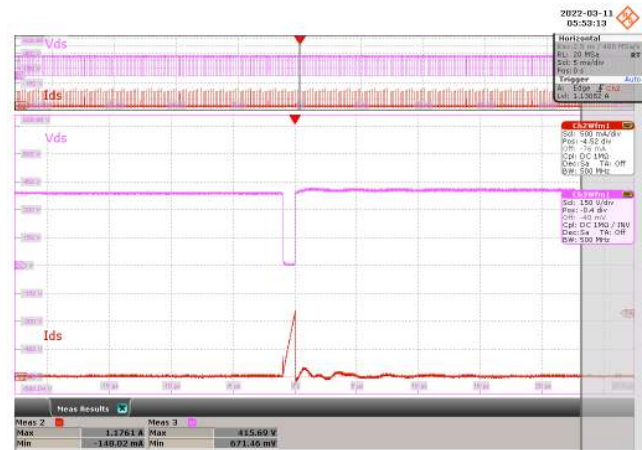
Figure 52 – 400 VDC Input. CH2: I_{DS} , 500 mA / div., 5 ms / div. CH3: V_{DS} , 150 V / div., 5 ms / div. Zoom: 5 \mu s / div. V_{DS(MAX)} = 415.69 V, I_{DS(MAX)} = 1.1761 A.
