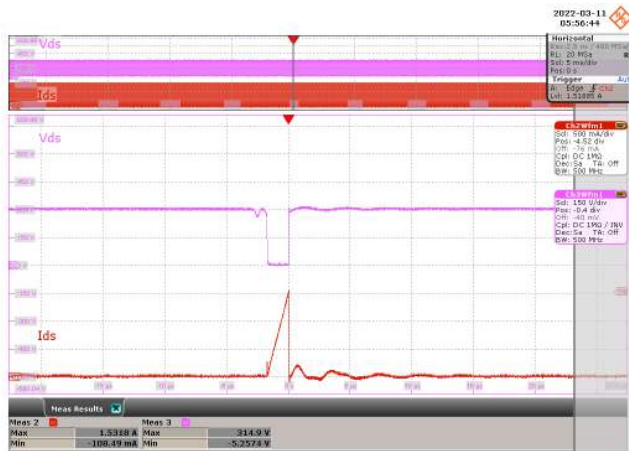
Figure 43 – 300 VDC Input. CH2: I_{DS} , 500 mA / div., 5 ms / div. CH3: V_{DS} , 150 V / div., 5 ms / div. Zoom: 5 \mu s / div. V_{DS(MAX)} = 314.9 V, I_{DS(MAX)} = 1.5318 A.
