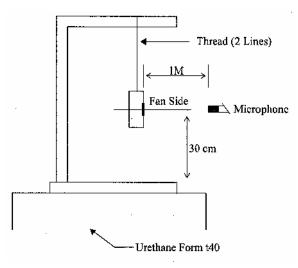
1 METER FROM MICROPHONE TO FAN INTAKE
