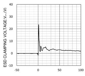
TIME(ns) ESD CLAMPING VOLTAGE (IEC61000-4-2 +8kV CONTACT)
