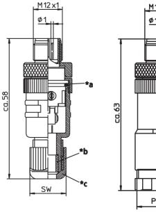
\*a O-Ring \*b gasket \*c cap nut
