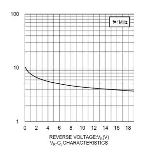
CAPACITANCE BETWEEN TERMINALS:C<sub>t</sub>(pF)
