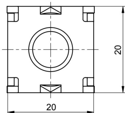
**Maximales Drehmoment bei M10: 31Nm**
